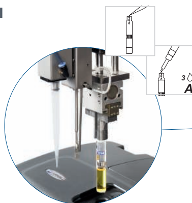
Bras polyvalent Saisi, transporte, mélange, pipette à l'aide de pointes à usage unique : voici le bras armé de l'AP 3800 multi.
